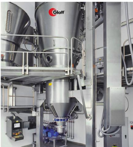
Wirbelschichtanlage mit Vakuum im Kreislaufbetrieb.
