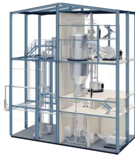
Wesentlicher Bestandteil des Pre-Engineerings ist ein Aufstellungsplan der Hauptausrüstung – hier mit Wirbelschichtgranulator als Herzstück der Anlage
